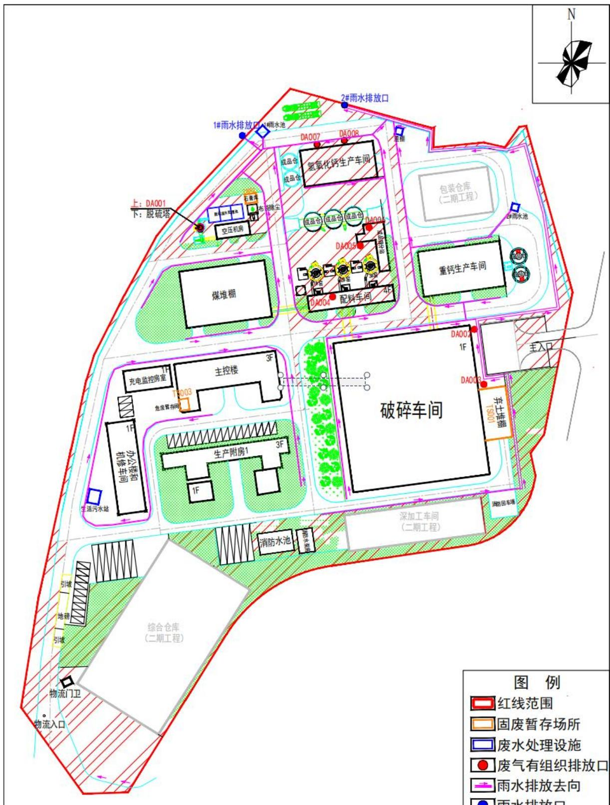
图 3.1-4 厂区平面布置及雨水管网分布图
